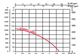
Las curvas de rendimiento se basan en los valores de viscosidad cinemática = 1 mm<sup>2</sup>/s y densidad igual a 1000 kg/m<sup>3</sup>. Tolerancia de curva según ISO 9906
